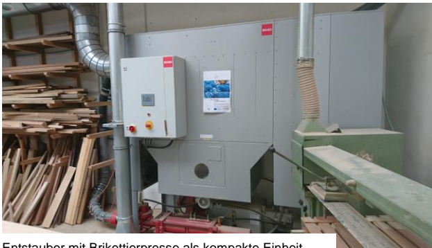
Entstauber mit Brikettierpresse als kompakte Einheit
