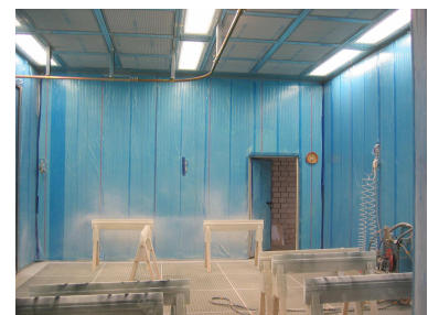
Pomieszczenie lakiernicze z odpyleniem kanałowym
