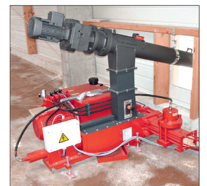
Brikettierpresse zur Brikettierung von Holzstäuben aus der Produktion
